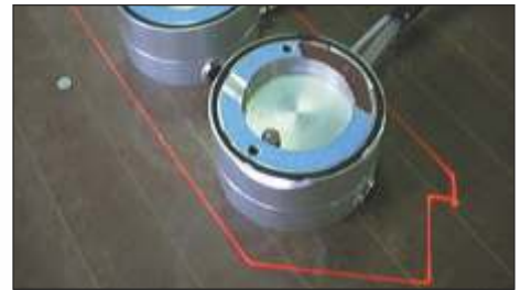
▲ Projectie van de werktekening op het werkblad van de CNC. De plaatsing van de bevestigingselementen wordt zeer eenvoudig.
