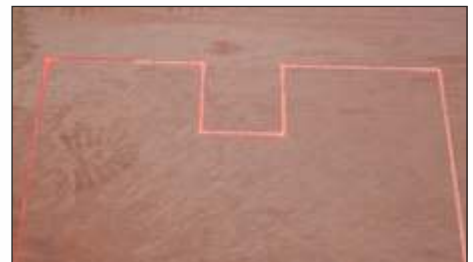
▲ Precieze projectie van het laserbeeld op het afgewerkt stuk als belangrijke visuele controle.
